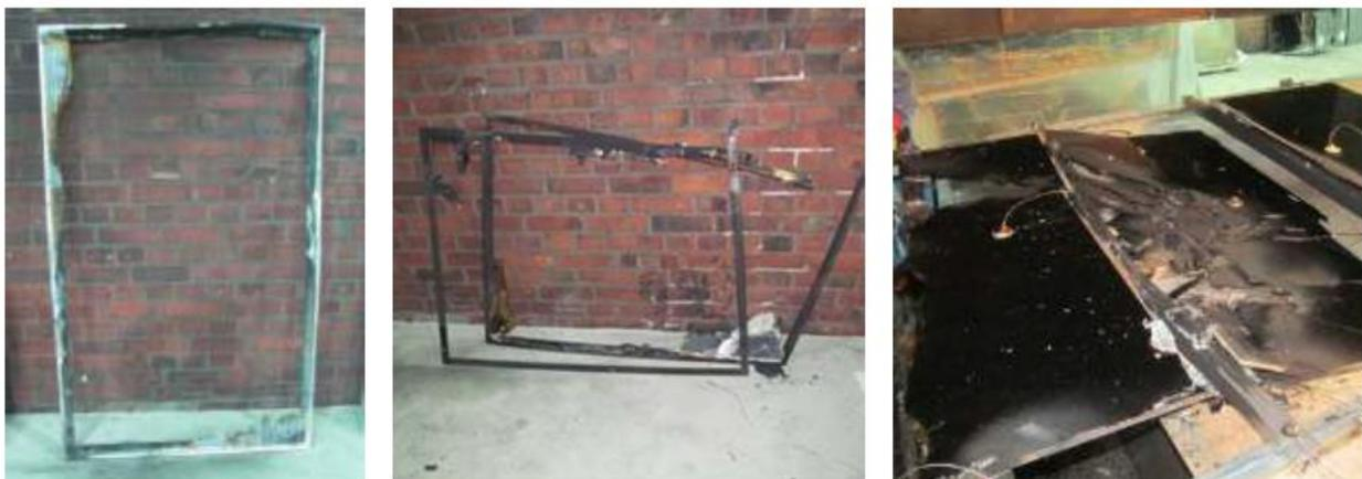
**Figura 3-3: Daños después de una solicitud con 150 kW de potencia del quemador, a la izquierda, c-Si, en el centro, CIS (puesto en sentido transversal) y a la derecha, CdTe (puesto en sentido transversal).**
