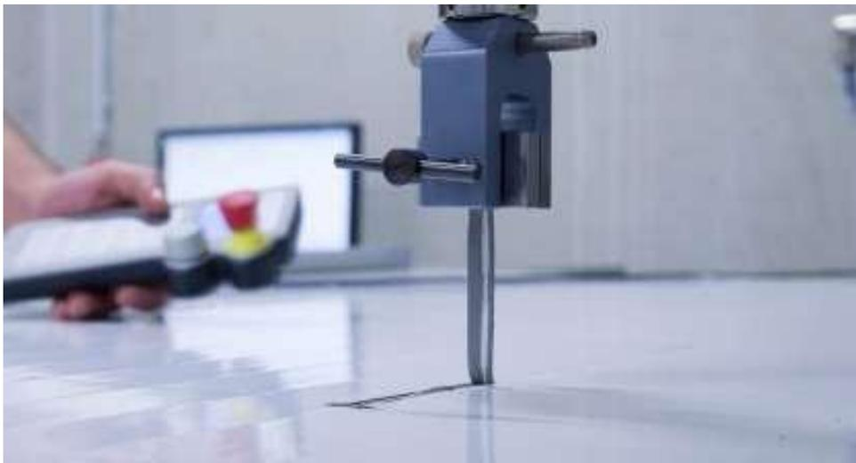
**Figura 5-16: Plataforma para probar la fuerza de despegado**
