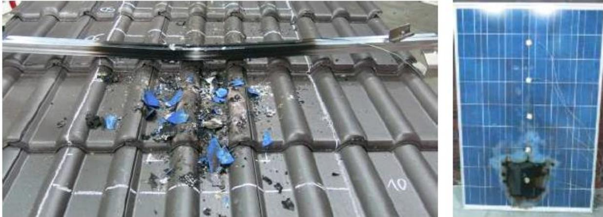
**Figura 5-32: Resultado después de la prueba. Se destruyó el módulo, el fuego no traspasó la superficie del techo**
