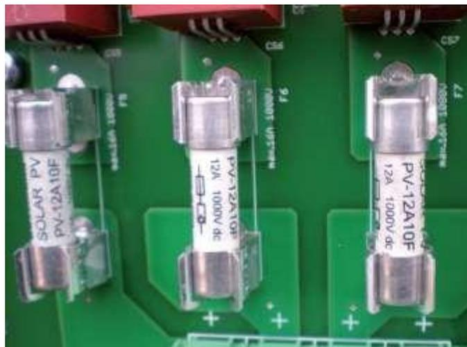
**Figura 3-52: Fusibles FV según la norma [Fuente: SIBA]**
