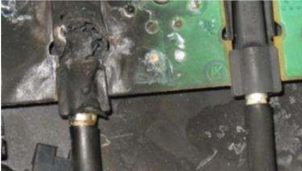
**Figura 3-27: Contactos enchufables dañados, en una caja de conexión del módulo.**
