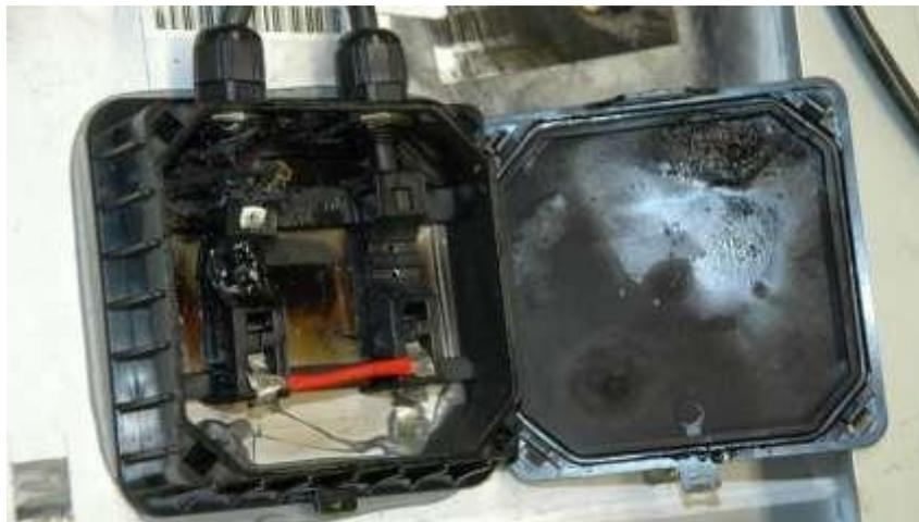
**Figura 3-43: Caja de conexiones después de un arco eléctrico entre el cable de conexión y el terminal de conexión [5].**
