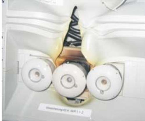
**Figura 3-30: fusible sobrecalentado (Foto: H. Godard, Energossa)**
