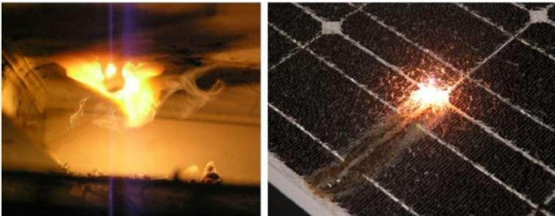
**Figura 3-42: Repercusiones de un arco eléctrico provocado al separar conductores de celdas. Fotos: TÜV Rheinland.**
