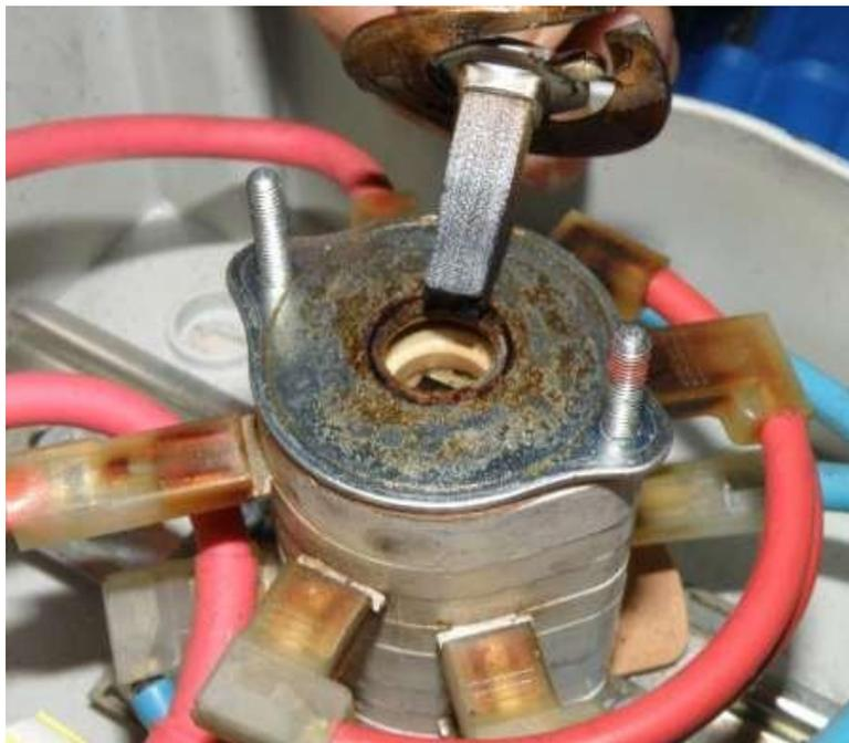
**Figura 3-24: Huellas claras de sobrecalentamiento en las conexiones y en el interior de un interruptor que “sobrevivió”.**
