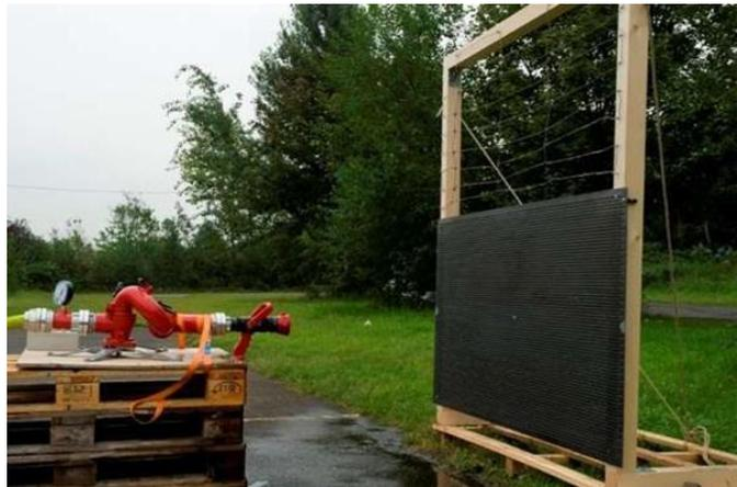
Figura 4-8: Montaje experimental con un módulo FV simulado (electrodo de metal perforado) y una boquilla a un metro de distancia.
