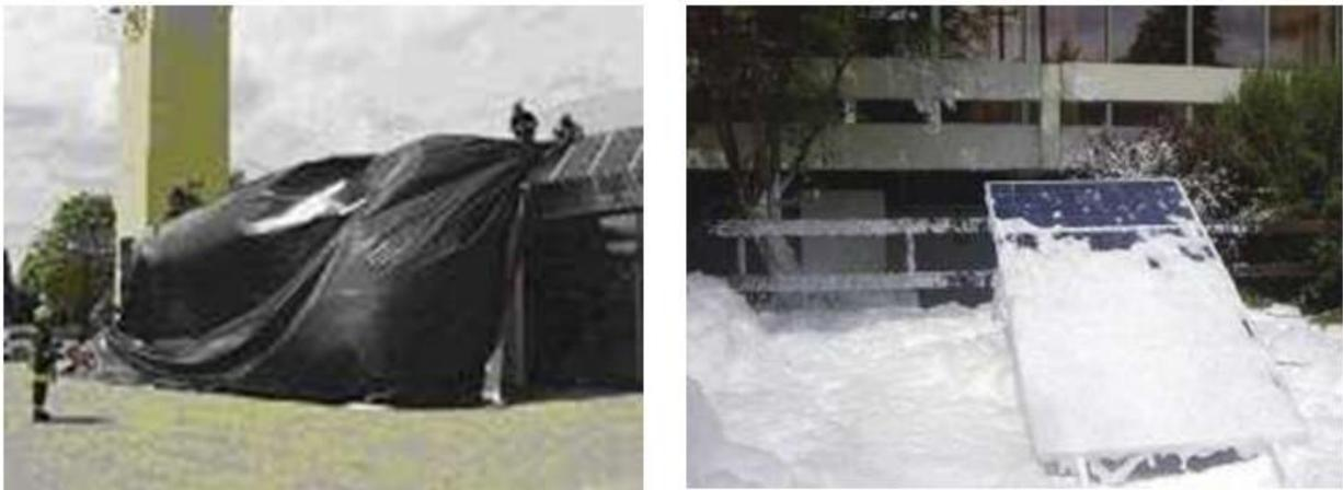
**Figura 5-44: Intentos de cobertura opaca de módulos FV, foto: <http://pv-notaus.de/gefahren.html>**
