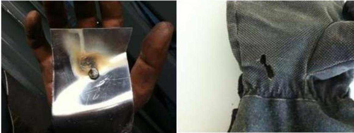
**Figura 4-20: Efecto de las corrientes en las superficies de contacto, perforación por quemadura, a causa de la acción de la corriente**
