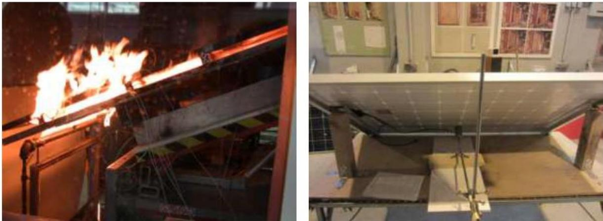
**Figura 3-5: A la izquierda: montaje experimental TÜV/Currenta con quemador de superficie. Foto: TÜV Rheinland. A la derecha: montaje experimental BAM con quemador de gas puntiforme en posicionamiento central, foto BAM [12].**
