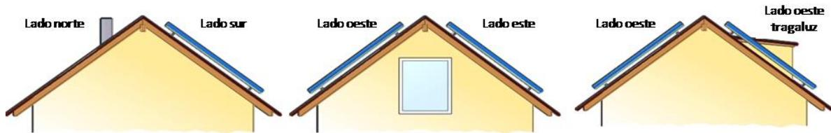
**Figura 5-27: Diversas posibilidades de acceso para el combate de incendios en techo inclinado [Fuente: DGS Berlín]**
