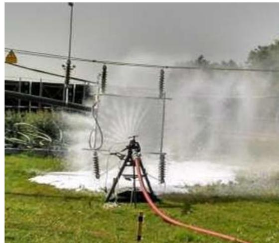
**Figura 4-18:** Medición de la corriente de fuga, extinción con espuma bajo chorro de neblina. Ensayos en terrenos de la OVAG, en 2014.
