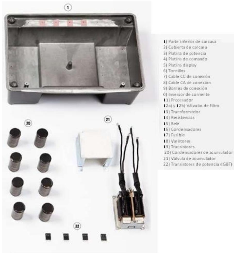
Figura 3-54: Componentes de un inversor de cadena [38]
