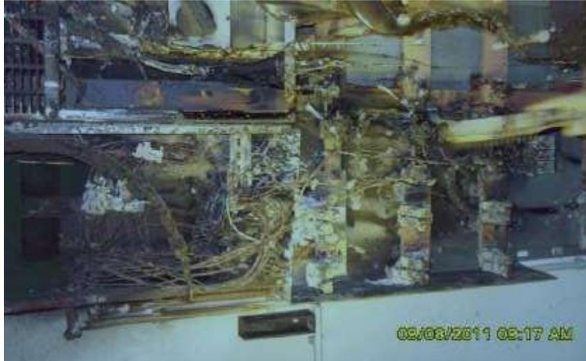
**Figura 3-28: Conexión CA de una planta FV quemada (Foto: Uli Motzer, compañía de seguros de Würtemberg)**
