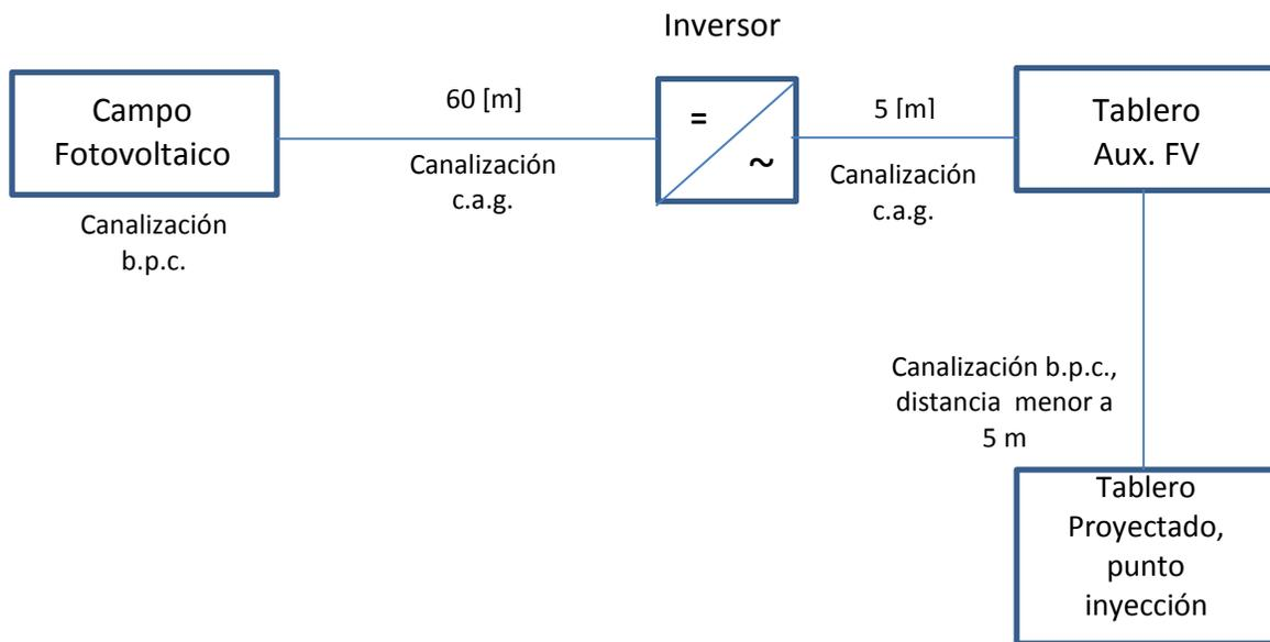
Se instalará un tablero Auxiliar FV a la salida del (los) inversor(es), con protecciones diferenciales y termomagnéticos tetrapolares.
