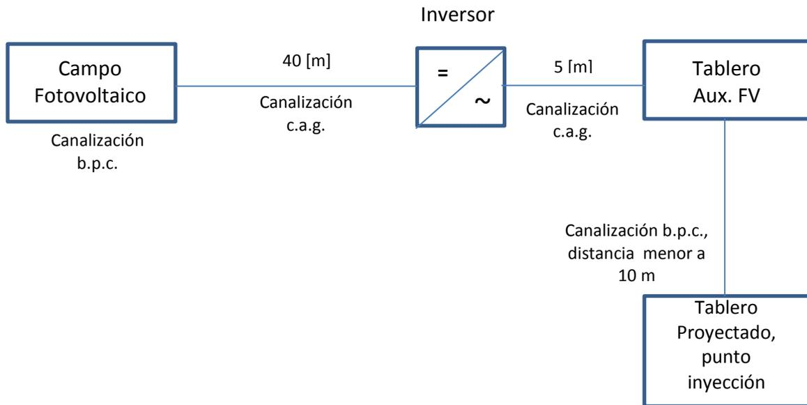
Se instalará a menos de 10 metros del punto de conexión, un tablero con una protección diferencial e interruptor general magnetotérmico tetrapolar.
