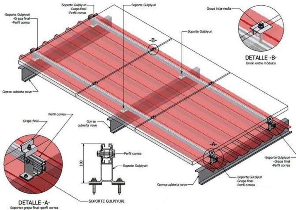
La siguiente figura muestra el detalle constructivo de las grapas finales e intermedias y del sistema de anclaje, incluida la solución de impermeabilización (junta EPDM)<sup>5</sup>, el cual se monta perforando la cubierta y fijándose a la estructura del techo.
