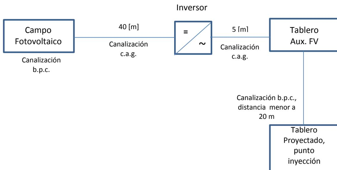
Se instalará en el tablero del punto de conexión, una protección diferencial e interruptor general magnetotérmico tetrapolar. Mientras que a la salida de el ó los inversores, se instalará un tablero Auxiliar FV con una sólo salida trifásica, que debe poseer una protección diferencial e interruptor magnetotérmico tripolar.
