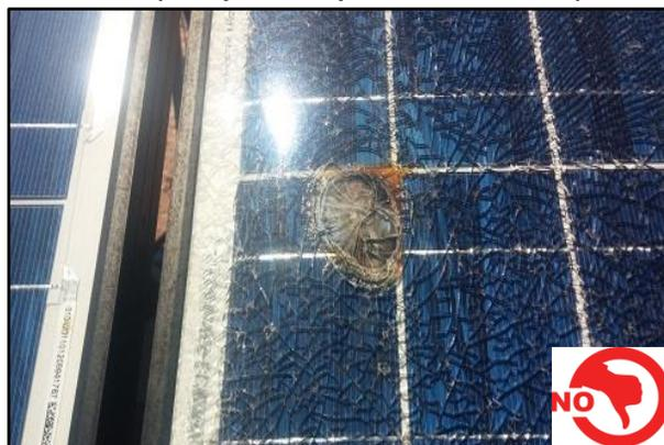
**Figura 119: Celda del panel en mal estado (este panel no puede ser utilizado)**
