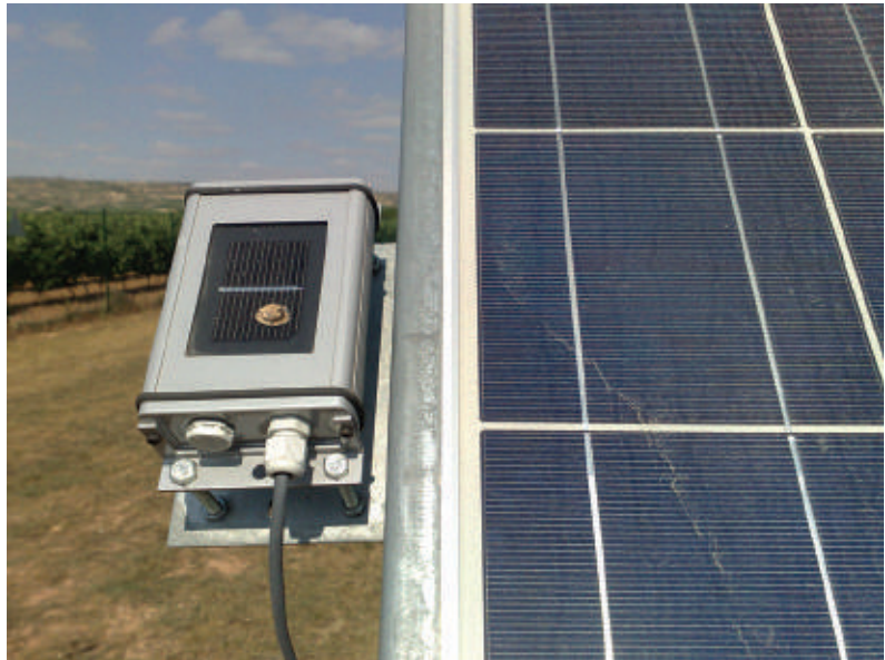
Ilustración 19 Sensor de radiación con suciedad, no se puede detectar en los datos de monitoreo fácilmente (Fuente: DGS Berlin e. V.)
