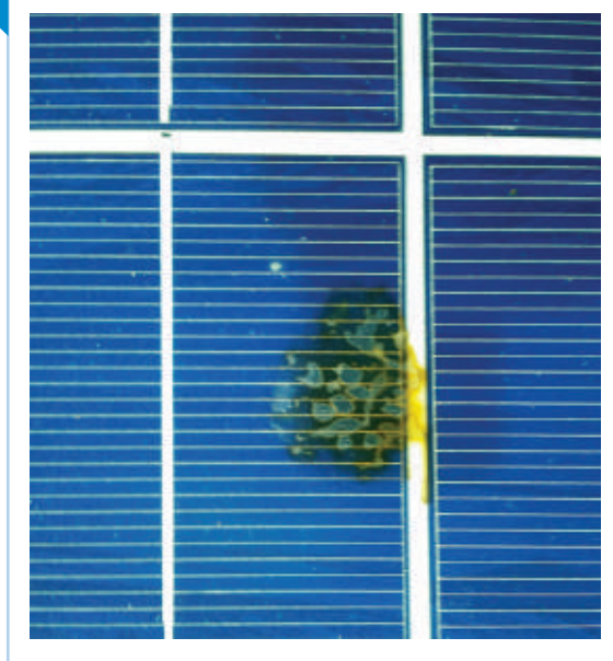
Ilustración 35 Comienzo de delaminación (Fuente: DGS Berlin e. V.)
