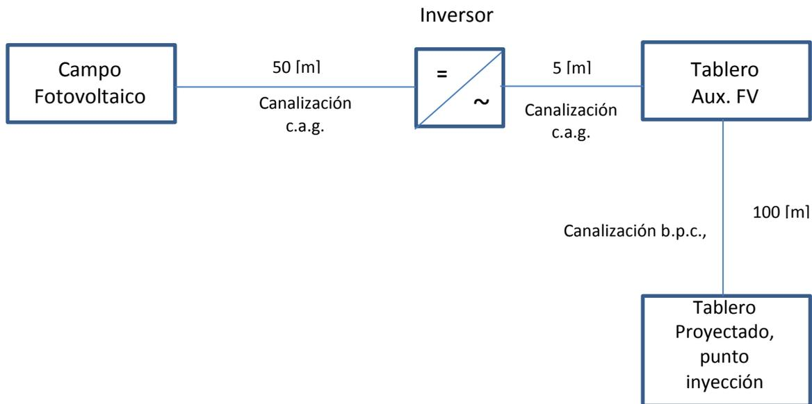
Se instalará un tablero Auxiliar FV a la salida del (los) inversor(es), con protecciones diferenciales y termomagnéticos tetrapolares. Además se instalará, en el tablero del punto de conexión, una protección diferencial tetrapolar e interruptor general magnetotérmico tetrapolar.
