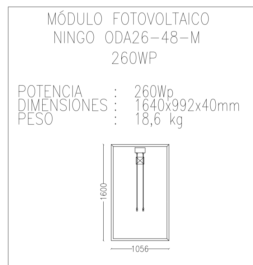
DETALLES PANELES FOTOVOLTAICO SIN ESCALA
