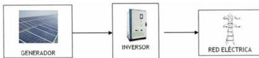
Ilustración 1 - Esquema básico de una instalación fotovoltaica conectada a la red eléctrica.
