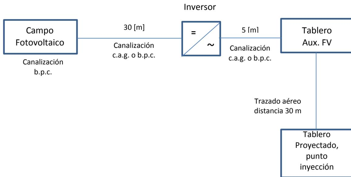
Se instalará un tablero Auxiliar FV a la salida del (los) inversor(es), con protecciones diferenciales y termomagnéticos tetrapolares. Además se instalará, a menos de 10 metros, del punto de conexión, un tablero con una protección diferencial tetrapolar y un interruptor general magnetotérmico tripolar.
