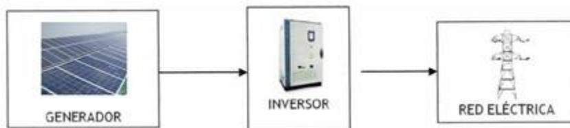
Ilustración 1 - Esquema básica de una instalación fotovoltaica conectada a la red eléctrica.
