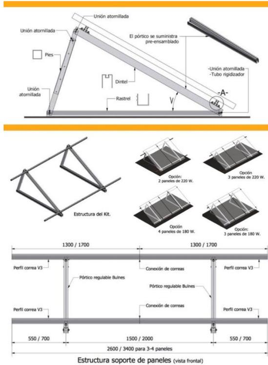
**Ilustración 11 - Estructura tipo inclinada sobre techo plano**
