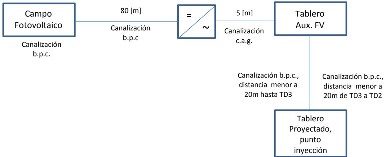
Se instalará un tablero Auxiliar FV a la salida del (los) inversor(es), con protecciones diferenciales y termomagnéticos tetrapolares. Además se instalará, a menos de 10 metros, del punto de conexión, un tablero con una protección diferencial tetrapolar y un interruptor general magnetotérmico tripolar.
