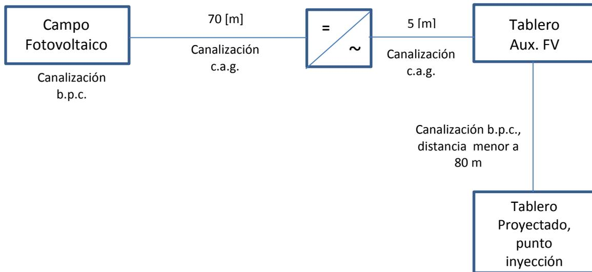
Se instalará un tablero Auxiliar FV a la salida del (los) inversor(es), con protecciones diferenciales y termomagnéticos tetrapolares. Además se instalará, en el tablero del punto de conexión, una protección diferencial tetrapolar e interruptor general magnetotérmico tripolar.
