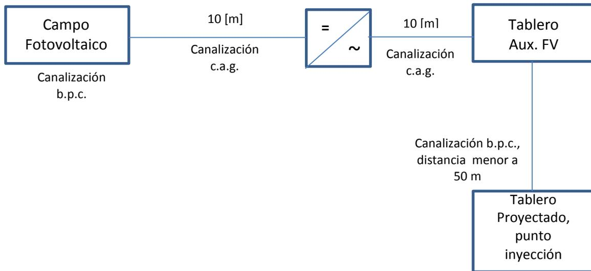
Se instalará un tablero Auxiliar FV a la salida del (los) inversor(es), con protecciones diferenciales y termomagnéticos tetrapolares. Además se instalará, a menos de 10 metros, del punto de conexión, un tablero con una protección diferencial tetrapolar y un interruptor general magnetotérmico tripolar.
