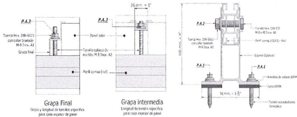
Ilustración 2. Sistema de montaje
