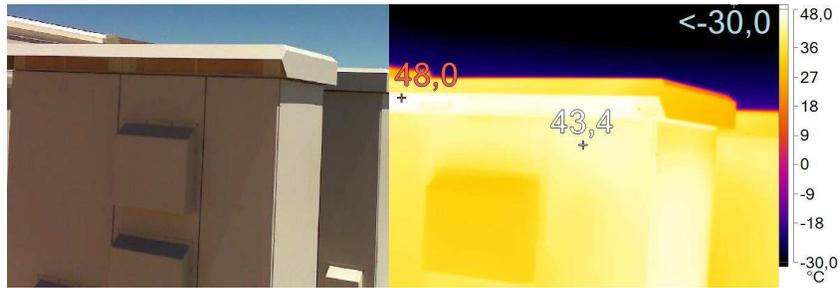
**ILUSTRACIÓN 77 SALA DE INVERSORES AFECTADA POR TEMPERATURAS ALTAS FRUTO DE LA MALA VENTILACIÓN
