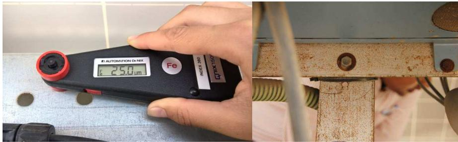
**ILUSTRACIÓN 66 IZQ: MEDICIÓN DE LA CAPA DE GALVANIZADO DEL PERFIL TRANSVERSAL DE LA ESTRUCTURA DE SUJECIÓN DE LOS PANELES (FUENTE: PI BERLÍN AG); DER: OXIDACIÓN DE LA SUPERFICIE DE LA ESTRUCTURA DE SUJECIÓN DE LOS PANELES (FUENTE: PI BERLÍN AG)**
