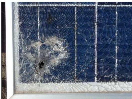
**ILUSTRACIÓN 44 ROTURA DE MÓDULO POR IMPACTO MECÁNICO - REEMPLAZAR EL MÓDULO.
