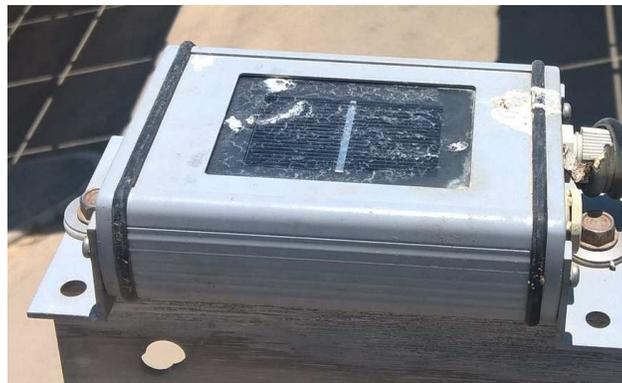
**ILUSTRACIÓN 23 SENSOR DE RADIACIÓN CON SUCIEDAD,
