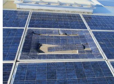
**ILUSTRACIÓN 75 PANEL INTEGRADO EN TEJADO DAÑADO POR SOBRECALENTAMIENTO (FUENTE: PI BERLIN AG)**
