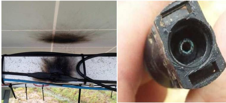
**ILUSTRACIÓN 63** EXPLOSIÓN DE LOS CONECTORES POR CORROSIÓN EN LA CONEXIÓN
