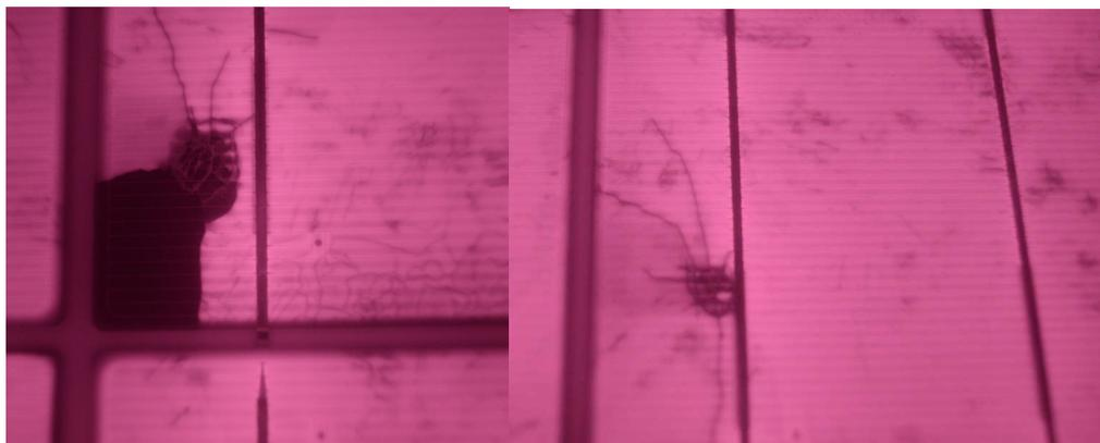
**ILUSTRACIÓN 34 EJEMPLOS DE IMPACTO DE HERRAMIENTA SOBRE LA PARTE POSTERIOR DEL
