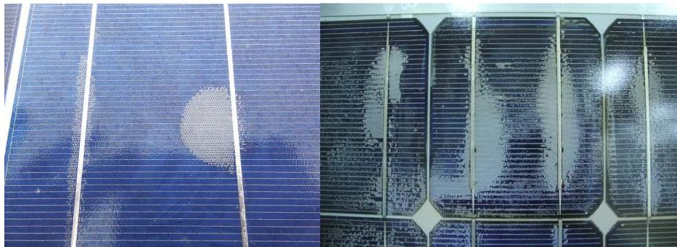
**ILUSTRACIÓN 46 DELAMINACIÓN DEL MÓDULO (FUENTE: PI BERLÍN AG)**
