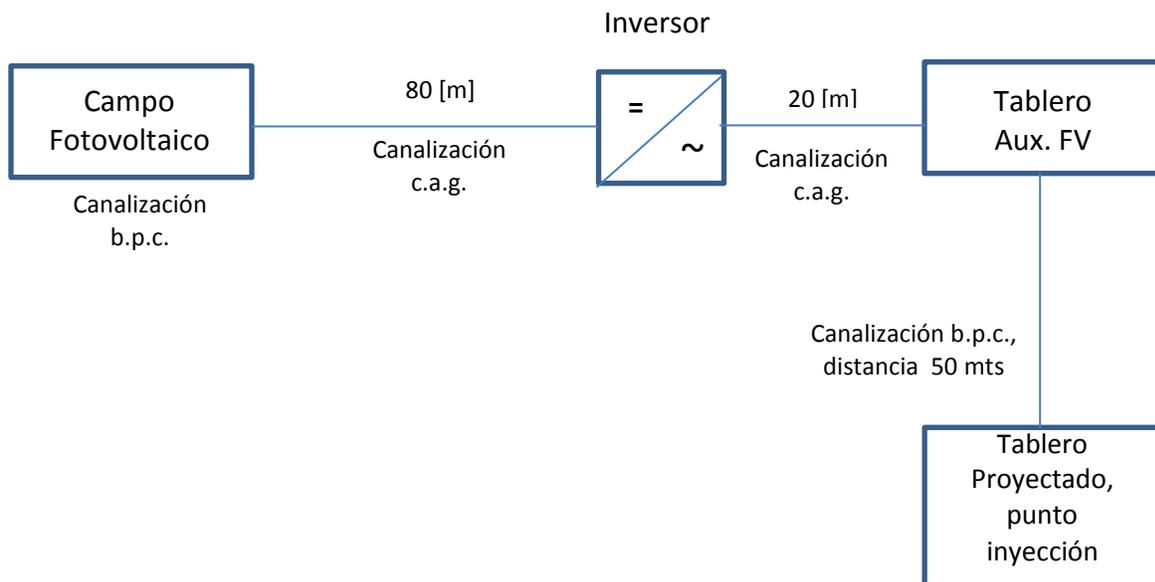
Se instalará un tablero Auxiliar FV a la salida del (los) inversor(es), con protecciones diferenciales y termomagnéticos tetrapolares. Además se instalará, a menos de 10 metros, del punto de conexión, un tablero con un interruptor general magnetotérmico Tripolar.
